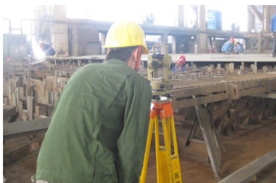
图 2-22 学生在船厂进行船体精确度测量
