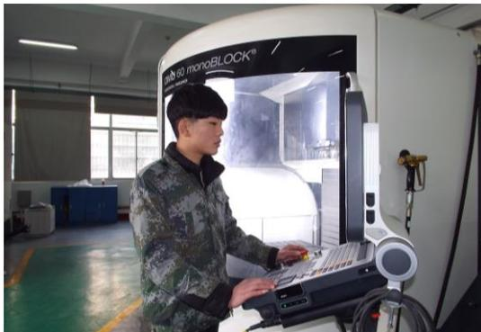
图 2-4 五轴加工中心（DMU60）操作训练
